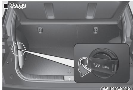
Электрическая розетка предназначена для питания мобильных телефонов или иных устройств, предназначенных для работы в электрической системе автомобиля. Устройства не должны потреблять более 180 Вт при работе двигателя.
