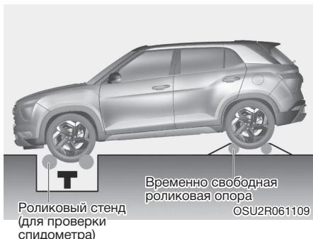
Роликовые стены для автомобилей с приводом на одну ось непригодны для проверки автомобилей с постоянным полным приводом. Если для проверки приходится использовать роликовый стенд, предназначенный для автомобилей с приводом на одну ось, выполните следующие действия.
