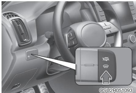
При работающем двигателе обогреватель нагревает ветровое стекло для устранения инея, запотевания и ледяного наледи изнутри и снаружи.
