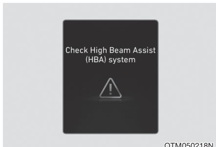
Если система автоматического управления дальним светом фар работает ненадлежащим образом, на комбинации приборов появляется предупреждающее сообщение «Проверьте систему автоматического управления дальним светом фар (НВА)» или «Проверьте НВА (систему автоматического управления дальним светом фар)» и загорается предупреждающий индикатор  $\triangle$ . Рекомендуется проверить систему уполномоченного производителем дилера / сервисного партнера.
