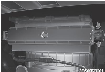
3. Снимите крышку воздушного фильтра системы управления микроклиматом при нажатии замка с правой стороны крышки.
