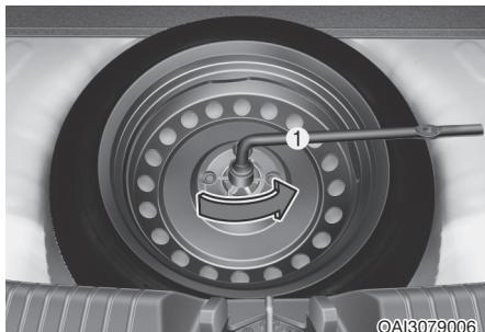
Если сложно вывернуть прижимной барашковый болт колеса вручную, его можно легко вывернуть, используя баллонный ключ.
