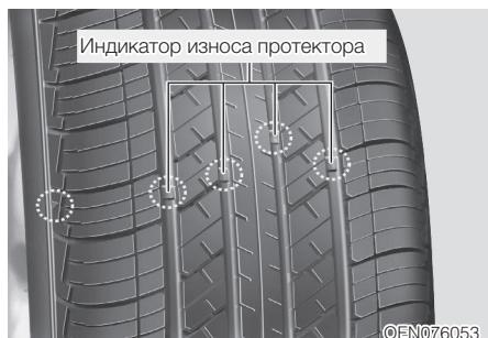
Если шина изношена равномерно, то индикатор износа появится в виде сплошной полосы, расположенной поперек протектора. Она означает, что нашине остался слой протектора толщиной менее 1,6 мм (1/16 дюйма). Если это произошло, замените шину.
