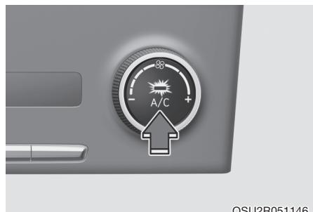
Для включения или выключения системы кондиционирования нажмите кнопку A/C (при этом загорится расположенный в ней индикатор).
