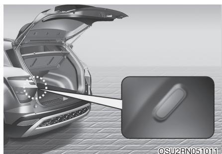
Плафон освещения багажного отделения включается при открытии двери багажного отделения.
