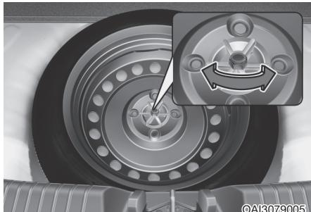
Вращайте барашковый прижимной болт против часовой стрелки для снятия запасного колеса.
