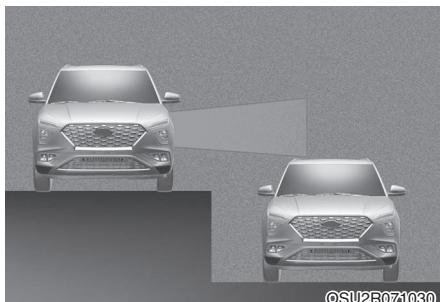
Система предупреждения о столкновении с объектом вне зоны видимости водителя может работать ненадлежащим образом при движении на участке с разной высотой полос движения. Функция может не обнаруживать транспортное средство на дороге с разной высотой полос движения (участки с разделением уровней, транспортные развязки и т. д.).
