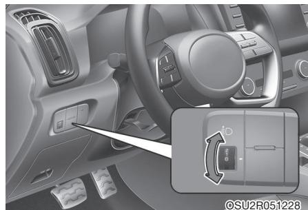
Для регулировки наклона фар в соответствии с количеством пассажиров и весом груза в багажном отделении следует повернуть ручку регулятора угла наклона фар.
