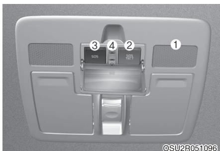
Компоненты системы ЭРА-ГЛОНАСС, установленные в салоне автомобиля:
