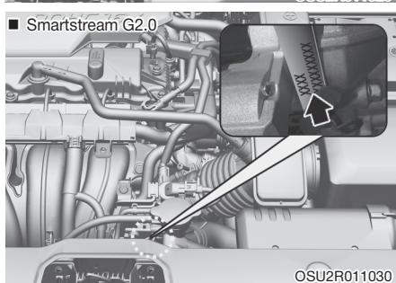
Серийный номер двигателя выштампован на блоке цилиндров (см. иллюстрацию).
