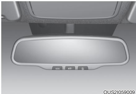
Электрическое зеркало заднего вида автоматически регулирует блики от фар позади идущих транспортных средств в ночное или темное время суток.
