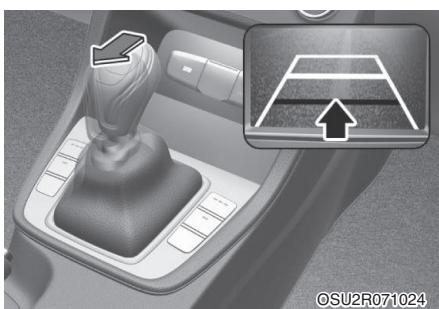
Камера заднего вида отображает пространства позади автомобиля для помощи водителю при парковке или движении задним ходом.
