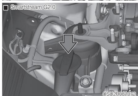
Проверьте уровень жидкости в бачке омывателя и долейте жидкость, если необходимо. При отсутствии специального раствора можно использовать чистую воду.
