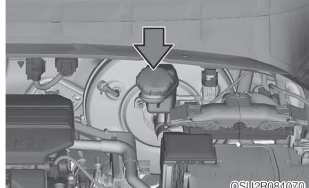
Периодически проверяйте уровень жидкости в бачке. Уровень жидкости должен находиться между рисками «MAX» (максимум) и «MIN» (минимум) на боковой поверхности бачка.
