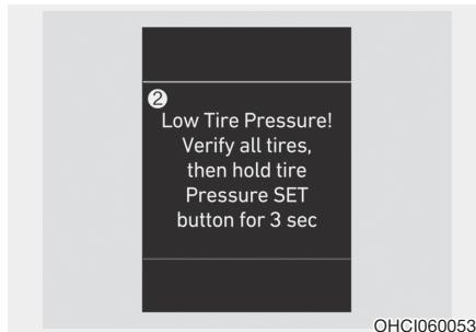
**Индикатор низкого давления в шинах / неисправности TPMS**
