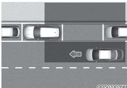
После остановки автомобиля, если при открывании двери пассажиром обнаружено транспортное средство, приближающееся сзади, система предупреждения об опасности выхода из автомобиля предупреждает водителя путем вывода сообщения на дисплей и звукового сигнала для предотвращения столкновения.
