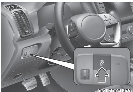
Электронная система динамической стабилизации (ESC) способствует сохранению устойчивости автомобиля на поворотах.
