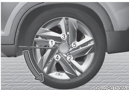
6. Ослабьте против часовой стрелки гайки крепления колеса, но не откручивайте их полностью, пока колесо не будет поднято над землей.
