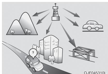
Радиосигнал диапазона FM передается на высоких частотах и не искривляется, проходя вдоль поверхности Земли. Поэтому, как правило, мощность таких радиосигналов начинает падать даже на небольшом расстоянии от передающей радиостанции. Кроме того, на их распространение оказывают влияние здания, рельеф местности или другие препятствия.
