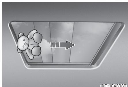
Если при автоматическом закрытии солнцезащитной шторки / панели люка будет обнаружено препятствие, солнцезащитная шторка / панель люка остановится и переместится в противоположном направлении, давая возможность удалить объект.
