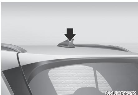
Антенна «акулий плавник» принимает передаваемые данные (например, сигналы AM/FM-радиостанций).
