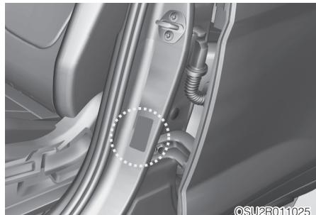
Все технические характеристики (размеры и давление) приведены в табличке, прикрепленной к автомобилю.
