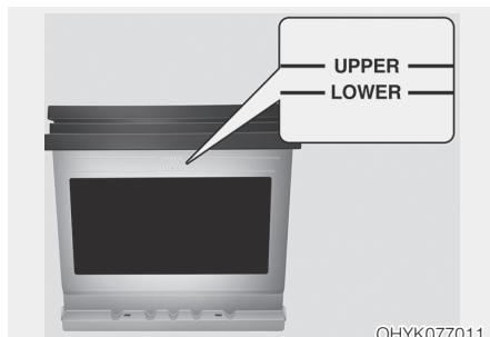
**Если на автомобиле установлена аккумуляторная батарея с метками LOWER (нижний (минимальный) уровень) и UPPER (верхний (максимальный) уровень) на боковой поверхности, следует проверить уровень электролита.**
