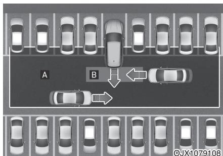
[A]: Рабочий диапазон функции предупреждения системы предупреждения столкновения с объектами, движущимися в поперечном направлении сзади автомобиля
