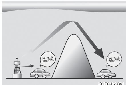
Сигнал AM передается на большее расстояние, чем сигнал FM. Это происходит потому, что радиоволны AM диапазона передаются на низких частотах. Эти радиосигналы с большой длиной волны и низкой частотой распространяются не по прямой линии в атмосфере, а могут огибать земную по-
