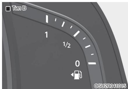
Этот указатель отображает примерное количество топлива в топливном баке.
