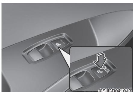
При работающем двигателе можно включить любой из обогревателей задних сидений.
