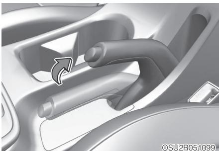
Проверьте ход рычага стояночного тормоза, подсчитав количество щелчков, слышимых при полном его включении из выключеного положения.
