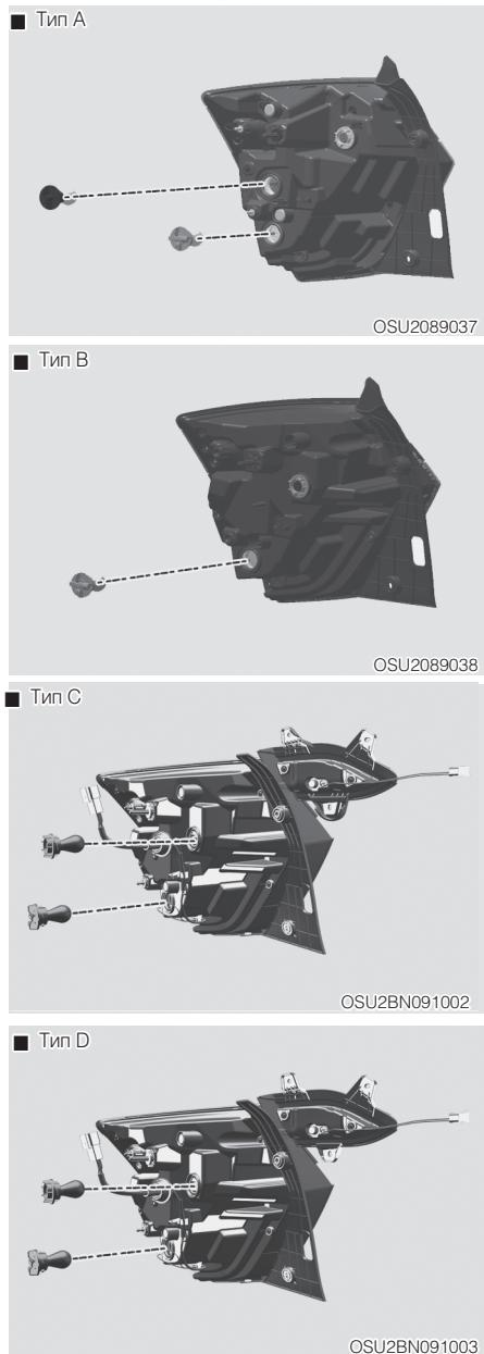
4. Извлеките из узла патрон, повернув его против часовой стрелки так, чтобы выступы патрона совместились с пазами в узле.
