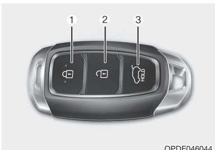
В автомобиле применяется электронный ключ, который можно использовать для блокировки или разблокировки дверей (и двери багажного отделения) и даже для запуска двигателя.
