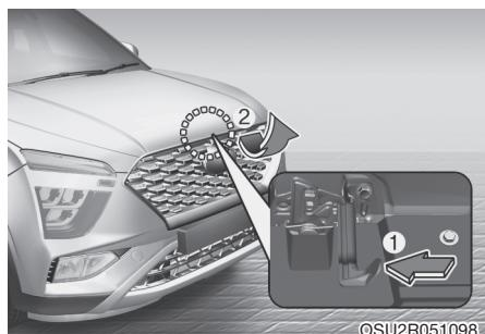
3. Подойдите к автомобилю спереди, приподнимите капот, поднимите вторичную защелку (1) по центру под капотом и откройте капот (2).
