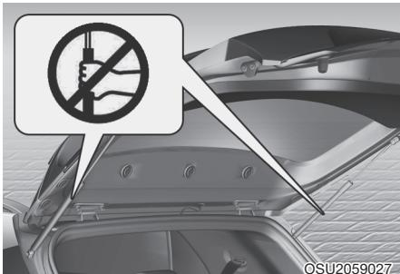
Не беритесь за детали (газонаполненные упоры), которые удерживают дверь багажного отделения в открытом положении. Помните о том, что в случае деформации детали возможно повреждение автомобиля или получение травмы.
