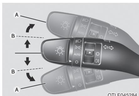
При переводе рычага в нижнее положение (A) включаются указатели левого поворота, в верхнее положение (A) — указатели правого поворота. Для включения сигнала перестроения необходимо слегка переместить рычаг переключателя указателей поворота и удерживать его в положении (B). После завершения поворота рычаг переключателя автоматически вернется в положение OFF.
