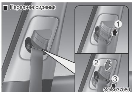
Для регулирования высоты крепления ремня безопасности следует сместить регулятор высоты в требуемое положение.
