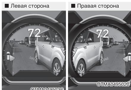
Система обнаружения объектов вне зоны видимости водителя отображает непросматриваемую зону сзади автомобиля на комбинации приборов при включенном указателе поворота для помощи при перестроении.
