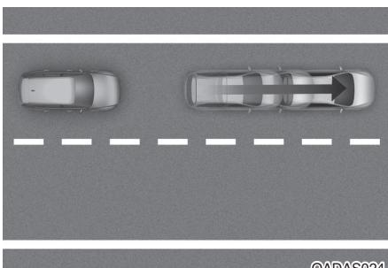
Если транспортное средство впереди резко начинает движение, система контроля внимания водителя может работать ненадлежащим образом.
