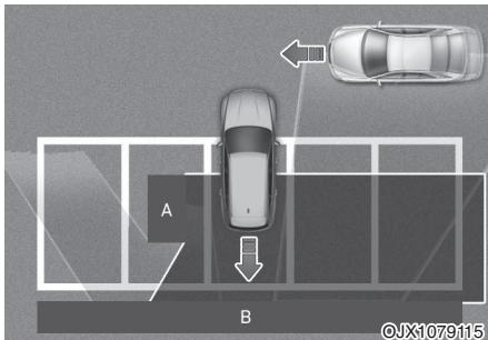
**Система предупреждения столкновения с объектами, движущимися в поперечном направлении позади автомобиля, может обнаруживать транспортные средства, проезжающие перед вашим автомобилем, когда ваш автомобиль заезжает на место для парковки, где есть стена или сооружение сзади или сбоку. Если это происходит, функция может подавать ложное предупреждение и задействовать тормоза, когда это не является необходимым.**
