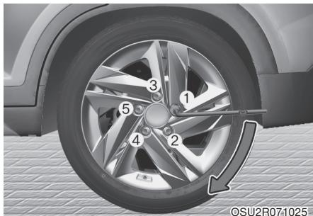
13. С помощью ключа для колесных гаек закрутите гайки крепления колеса в показанной последовательности. Выполните повторный контроль затяжки каждой гайки. После замены колес следует как можно быстрее обратиться к уполномоченному производителю дилеру/сервисному партнеру для затяжки гаек крепления колеса номинальным моментом. **Момент затяжки гаек крепления колеса: 11–13 кгс·м (79–94 фунт-сила·фут).**
