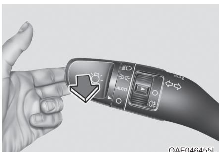
Для мигания дальним светом фар следует потянуть рычаг на себя и отпустить. Дальний свет остается включенным, пока не отпущен рычаг.
