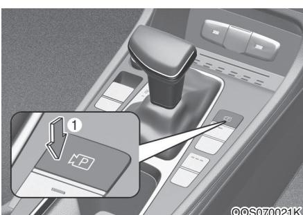
Кнопка выключателя системы обзора при парковке (при наличии)
