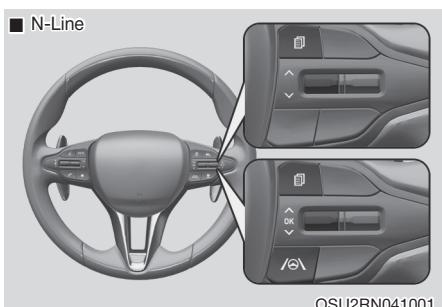
Для изменения режима суточного пробега нажмите переключатель « $\wedge$ ,  $\vee$ » на рулевом колесе.
