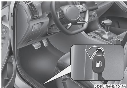
Крышка люка топливозаливной горловины открывается ручкой изнутри автомобиля.
