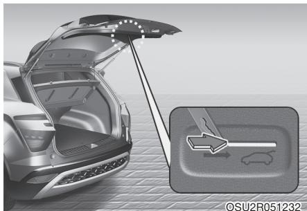
Автомобиль оснащен устройством аварийного отпирания двери багажного отделения, расположенным в ее нижней части. В случае непреднамеренного запирания человека в багажнике крышку можно открыть следующим образом:
