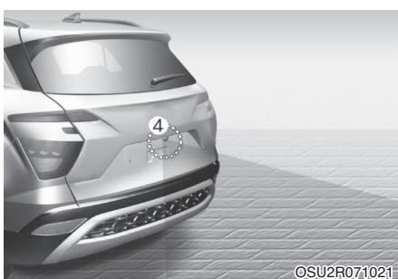
Система кругового обзора помогает водителю во время парковки с помощью камер, установленных на автомобиле, и отображает пространство вокруг автомобиля на экране информационно-развлекательной системы.
