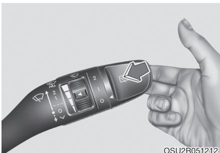
При нахождении рычага в положении О (Выкл.) слегка потяните его на себя для подачи жидкости на ветровое стекло и включения стеклоочистителей на 1–3 цикла работы. Работа стеклоомывателя и стеклоочистителя будет продолжаться до тех пор, пока вы не отпустите рычаг.
