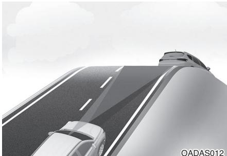
При движении на подъеме или спуске система интеллектуального круиз-контроля может не обнаружить транспортное средство, движущееся в вашей полосе, и ваш автомобиль может ускориться до заданной скорости. Кроме того, скорость автомобиля может резко снизиться при внезапном обнаружении транспортного средства впереди.
