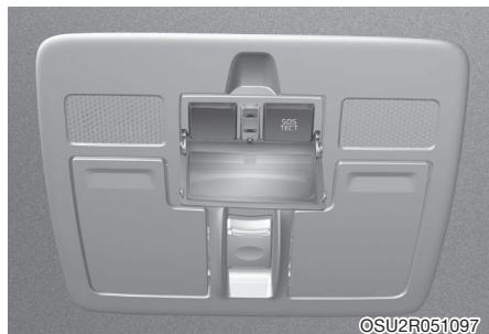
Компоненты системы ЭРА-ГЛОНАСС, установленные в салоне автомобиля:
