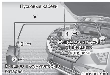
4. Присоедините кабели для запуска двигателя от внешнего источника (пусковые кабели), строго следуя указанной на рисунке последовательности. Сначала подсоедините один конец пускового кабеля к красному плюсовому (+) выводу разряженной АКБ (1).
