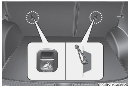
Крепления верхнего привязанного ремня системы безопасности для детей находятся на полу багажного отделения.
