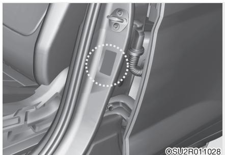
Сертификационная табличка автомобиля, закрепленная на средней стойке кузова со стороны водителя или переднего пассажира, также содержит идентификационный номер автомобиля (VIN).
