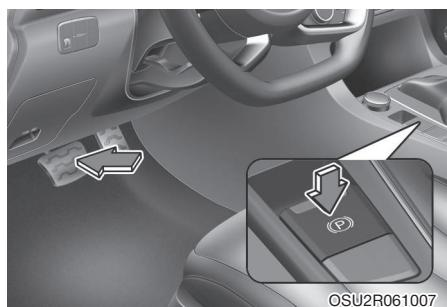
Чтобы отпустить EPB (электрический стояночный тормоз), нажмите выключатель EPB при следующих условиях:
