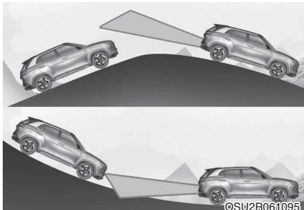
Система предупреждения о столкновении с объектом вне зоны видимости водителя может работать ненадлежащим образом при движении по склонам. Функция может не обнаруживать транспортное средство, движущееся по соседней полосе, или подавать ложные предупреждения при обнаружении грунта или сооружения.
