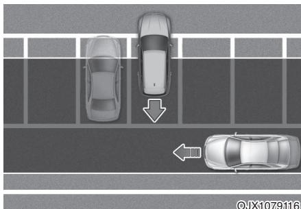
**Система предупреждения столкновения с объектами, движущимися в поперечном направлении позади автомобиля, может обнаруживать транспортные средства, проезжающие сзади вашего автомобиля, когда ваш автомобиль заезжает на место для парковки задним ходом. Если это происходит, функция может подавать ложное предупреждение и задействовать тормоза, когда это не является необходимым.**
