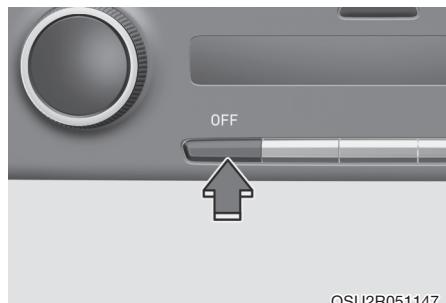
Нажмите кнопку OFF для выключения системы автоматического управления микроклиматом. При этом сохраняется возможность управления кнопками выбора режимов распределения и забора воздуха при включенном зажигании.
