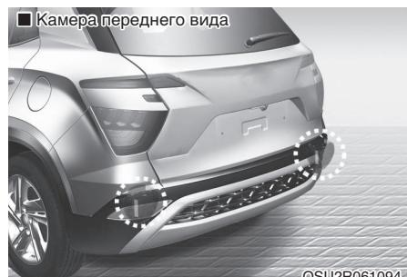
Задние угловые радары представляют собой датчики, расположенные внутри заднего бампера, которые обнаруживают объекты сзади и сбоку автомобиля. Всегда следите за чистотой поверхности заднего бампера для надлежащей работы системы предупреждения об опасности выхода из автомобиля.
