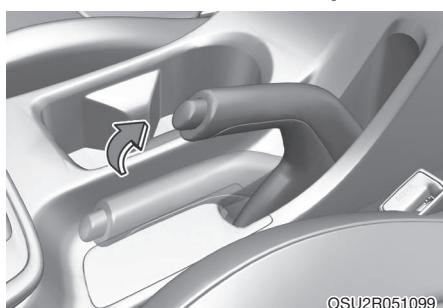
Прежде чем покинуть автомобиль, обязательно задействуйте стояночный тормоз.
