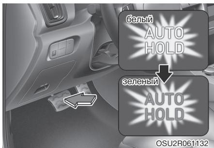
2. При полной остановке автомобиля педалью тормоза система автоматического удержания поддерживает тормозное давление для удержания автомобиля на месте. Цвет индикатора изменится с белого на зеленый.
