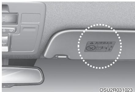
Предупреждающие наклейки прикрепляются к модулям подушек безопасности для того, чтобы уведомить водителя и пассажиров об опасности, связанной с системой подушек безопасности. Необходимо ознакомиться с предупреждениями в отношении системы подушек безопасности, изложенными в руководстве по эксплуатации.
