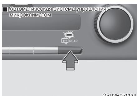
При работающем двигателе обогреватель нагревает заднее стекло для устранения инея, запотевания и ледяного наледи изнутри и снаружи.
