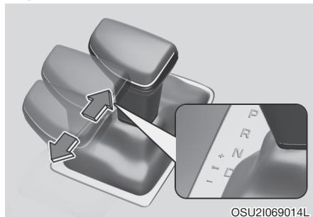
Чтобы активировать режим ручного переключения передач, следует (при неподвижном или движущемся автомобиле) перевести рычаг селектора из положения D (движение) в сектор ручного переключения. Для возврата в режим D (движение) верните рычаг в основной сектор.
