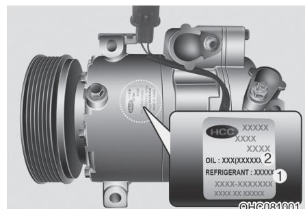
На этикетке компрессора указаны модель, номер по каталогу поставщика и серийный номер компрессора, тип хладагента (1) и тип компрессорного масла (2).
