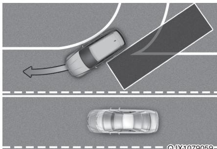
Система предупреждения о столкновении с объектом вне зоны видимости водителя может работать ненадлежащим образом при движении на участке слияния или разделения дороги. Система предупреждения о столкновении с объектом вне зоны видимости водителя может не обнаруживать транспортное средство, движущееся по соседней полосе.
